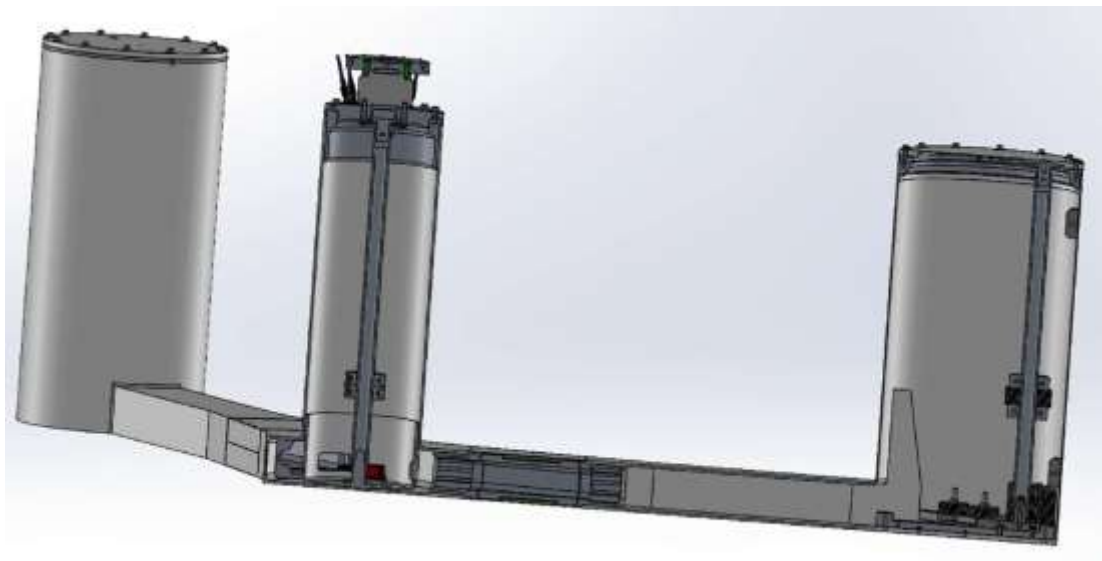
Figure 3: Coupe longitudinale de la maquette de plateforme, avec les éléments coque en carbone
