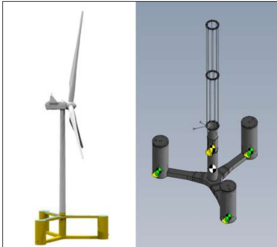
Figure 2 : Vue de l'éolienne flottante INO OptiFLEX 22 MW (à gauche) et de la maquette CIMSUB (à droite). La nacelle représentant la nacelle et le rotor, ainsi que le mât ne sont pas représentés sur la maquette (et ne sont pas inclus dans ce marché)
