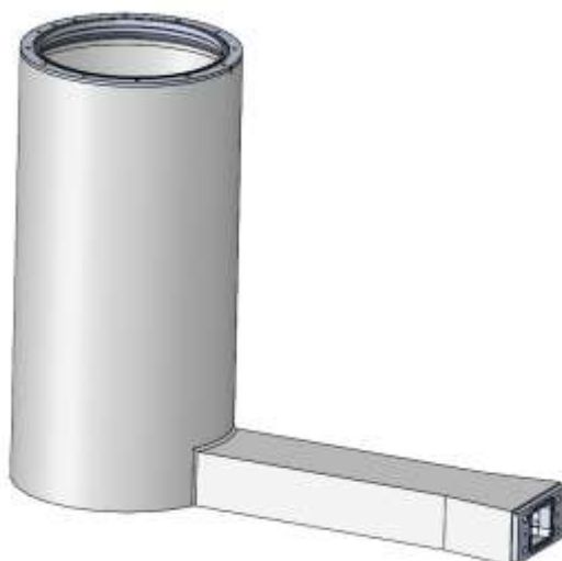
Figure 4 : Coque et inserts d'une colonne périphérique
