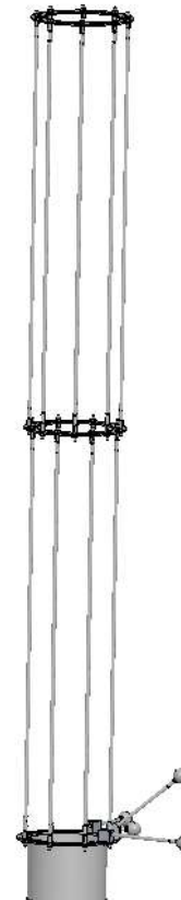
Figure 8: Cadre support d'instrumentation en carbone
